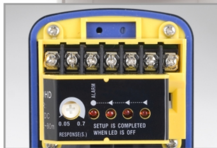
數位式光束強度指示，LED組成10段位階，能快速、準確光學對焦，不需動用三用錶。
